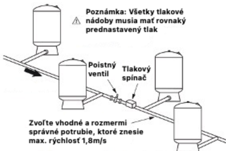
Obr. 1.5 Inštalácia viacerých tlakových nádob
